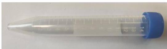
Рис. 13.7 Градуированная полимерная пробирка с крышкой.
