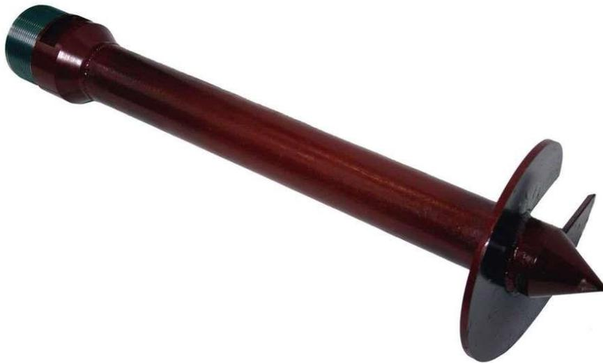
Рис. 6.2. Винтовой штамп IV типа площадью 600 см<sup>2</sup>.
