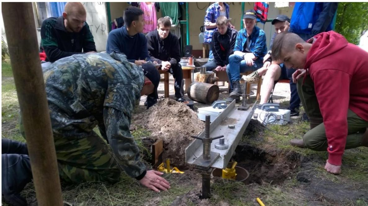
Рис. 5.2 - Проведение среза целика грунта в шурфе
