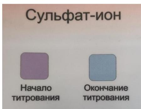
Рис. 13.14 Контрольная шкала образцов окраски начала и окончания титрования для определения сульфат-иона
