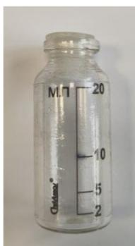
Рис. 13.4 Мерная склянка с метками и пробкой.
