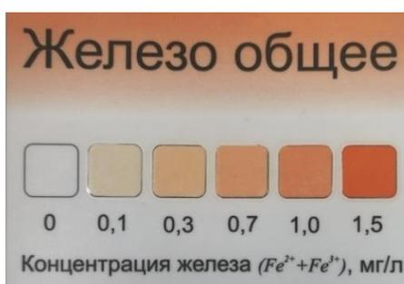
Рис. 13.13 Контрольная цветовая шкала образцов окраски растворов для определения железа общего
