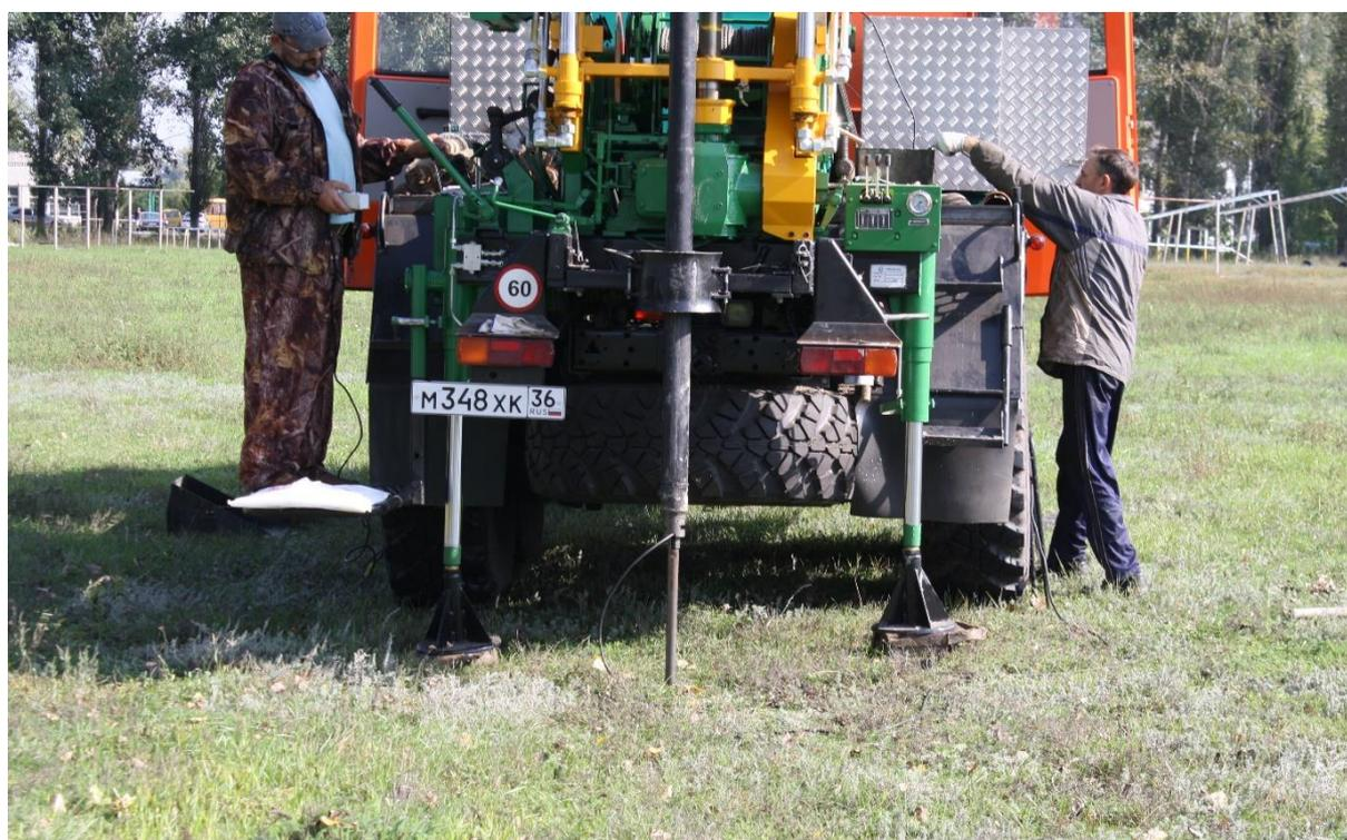
Рис. 4.1 Статическое зондирование с помощью гидравлической мачты самоходной буровой установки ПБУ-2 300.
