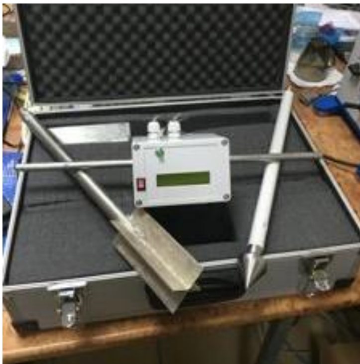
Рис. 6.4 Прибор вращательного среза в комплекте (с электрическим устройством измерения крутящего момента) производства НПП «ГЕОТЕК»
