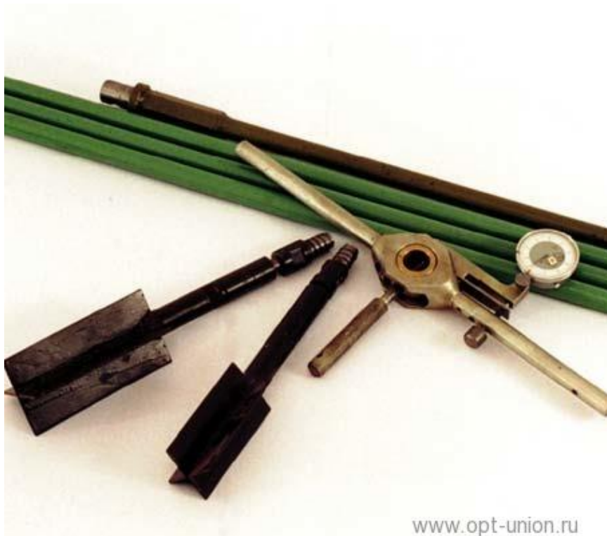
Рис. 6.3 Прибор вращательного среза в комплекте (с механическим устройством измерения крутящего момента)
