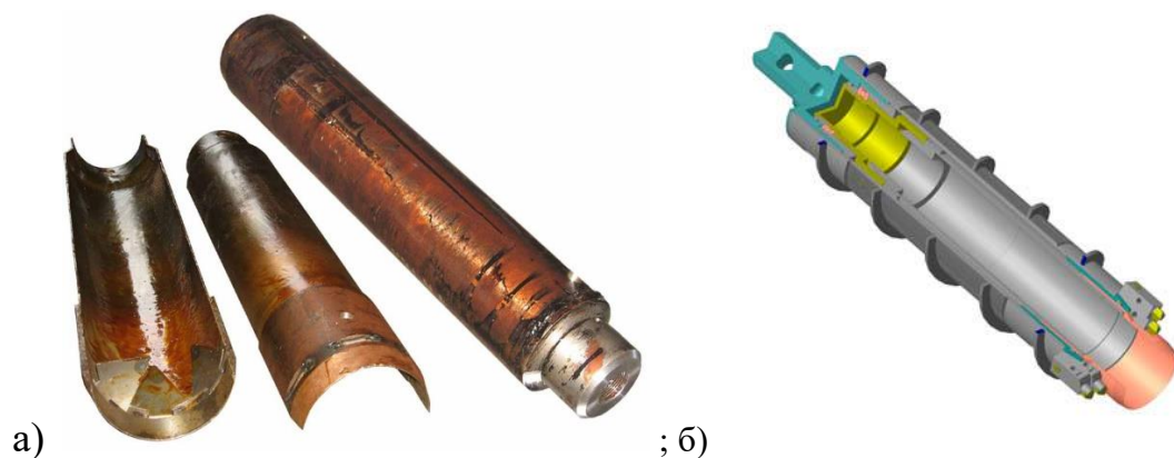
Рис. 3.2 - Грунтоносы: а) задавливаемый; б) обуривающий (ПШН-185).
