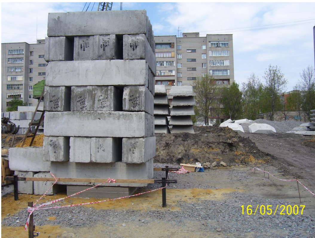
Рис. 7.5 Штапмовые испытания грунтов на глубинне заложения фундамента штампом площадью 5000 см 2 .
