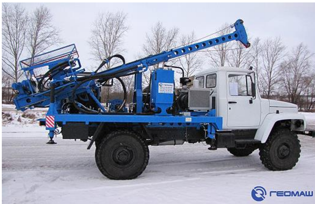
Рис. 1. УГБ 001 на основе ГАЗ-33081 «Садко»
