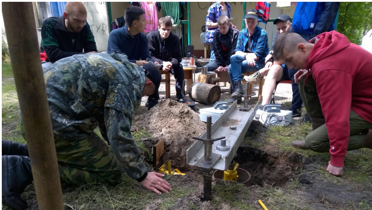
Рис. 5.5 - Проведение среза целика грунта в шурфе
