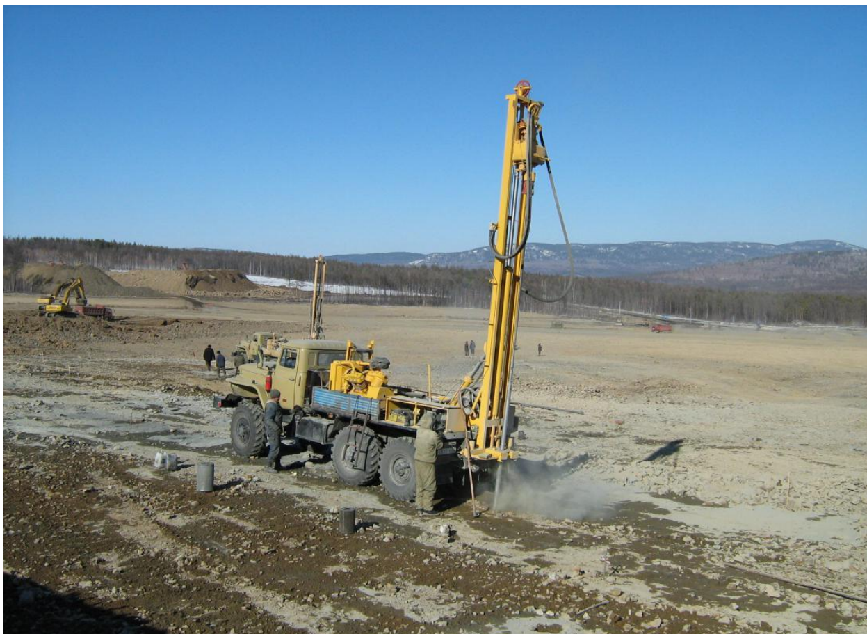
Рис. 4. Установки завода им. Воровского УРБ-2А2, УРБ-2А2Д
