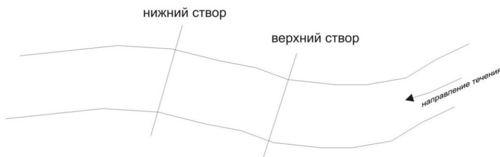
Рис. 4.3 - Схема расположения створов при измерении скорости течения поплавками.
