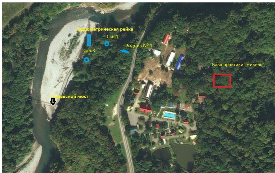
Рис. 2.2 - Схема расположения наблюдательных скважин и родника.
